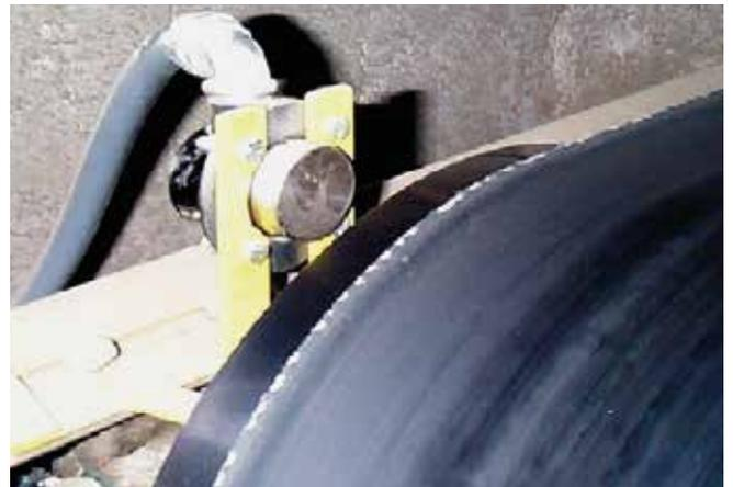
*Aplicación del sensor en una banda abierta.*
